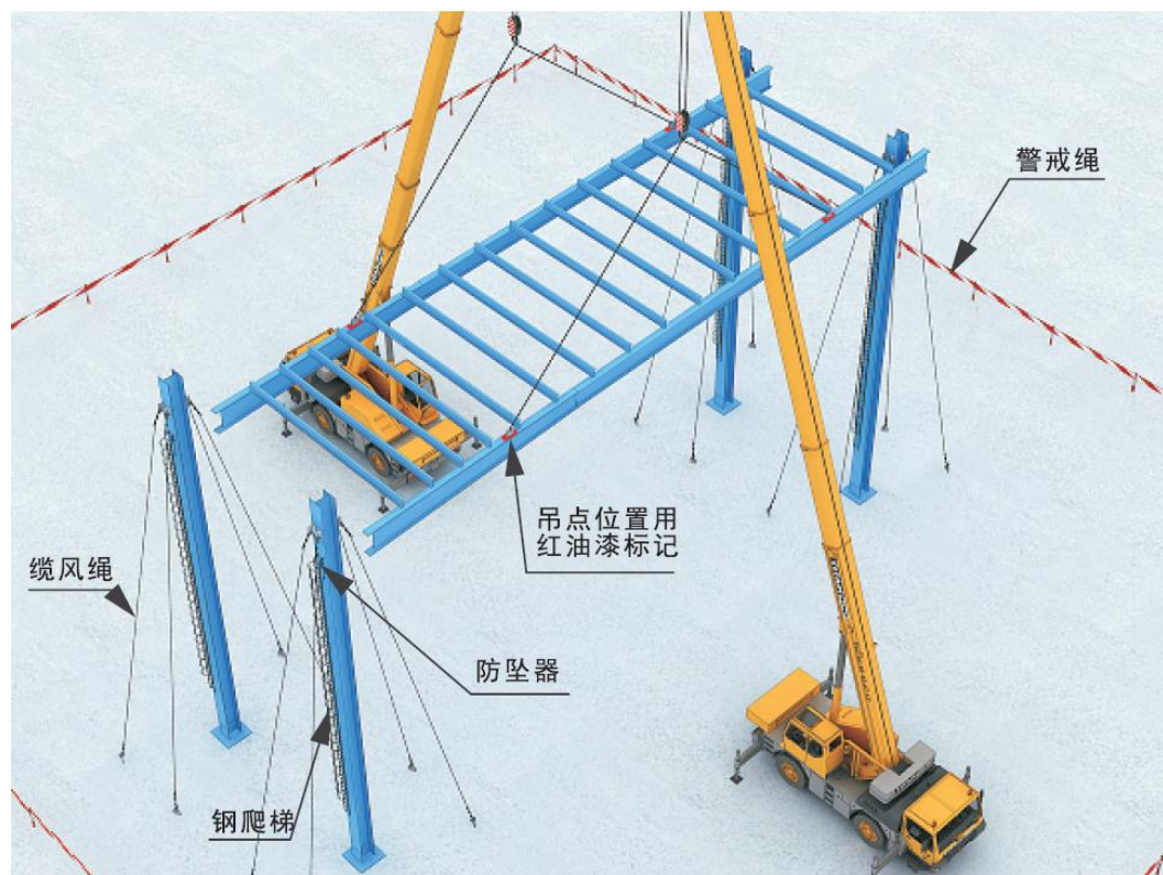
钢架施工示意图
