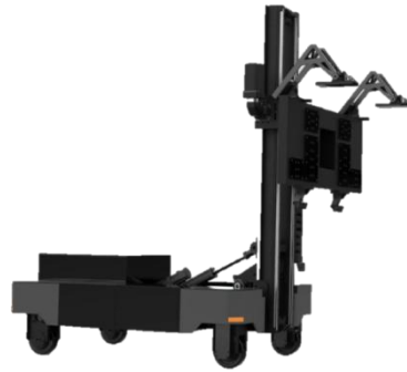
条板安装机器人
