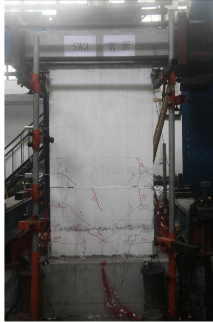
我院基于钢结构连接技术的装配式结构体系试验
