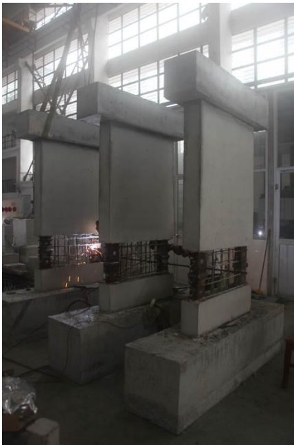
我院基于钢结构连接技术的装配式结构体系试验
