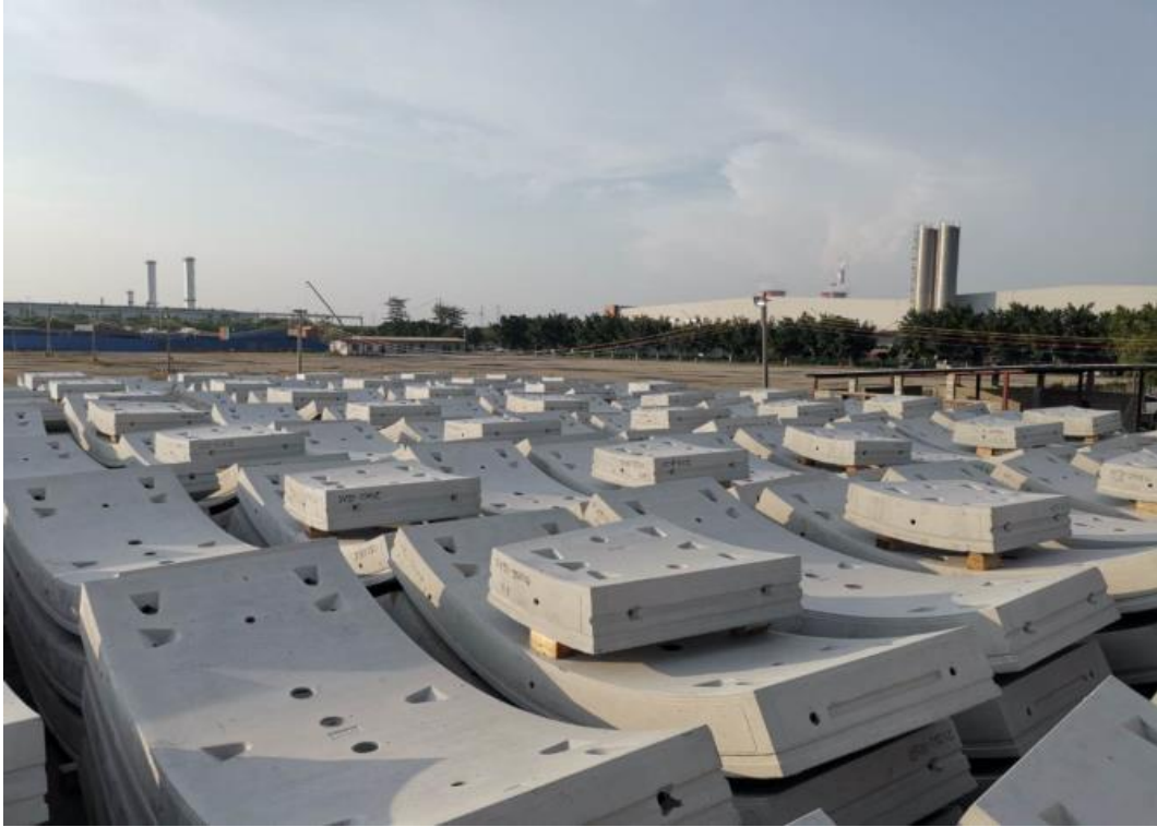
南沙分公司预制管片生产场地
