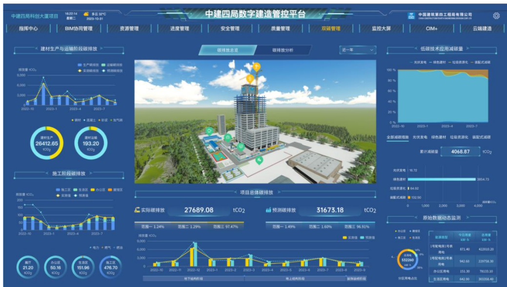
中建四局建造碳排放监测平台
