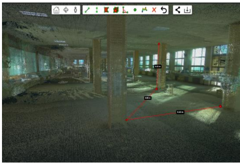
建筑三维扫描
