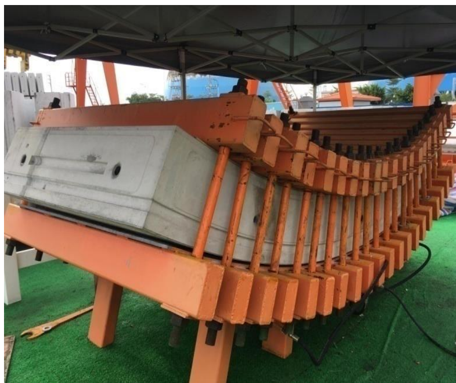
预制管片试验装置
